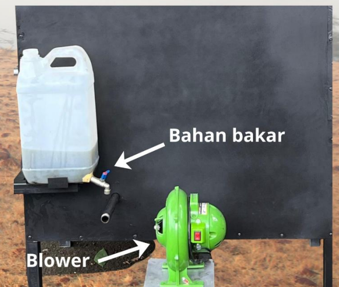
Gambar 18. Ilustrasi Sistem Kerja Mesin Burner (1)
