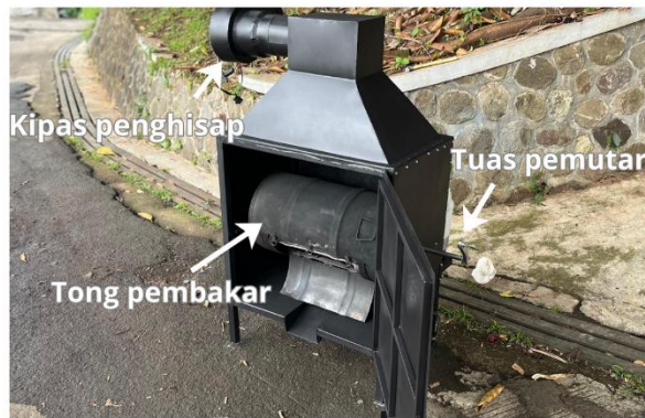
Gambar 19. Ilustrasi Sistem Kerja Mesin Burner (2)
